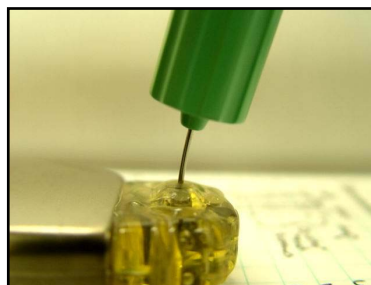
Abb. 1. Schraubendreher um 20° bis 30° aus der Senkrechten biegen.
