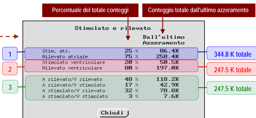
Figura 2. Dettaglio dei Contatori Stimolato e rilevato del pacemaker ALTRUA.
